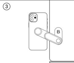
Reinigen Sie die Oberfläche des Geräts, bevor Sie fortfahren. Öffnen Sie die EDGE Mount und schnappen Sie Ihr Telefon darauf, finden Sie die gewünschte Position auf Ihrem Gerät und drücken Sie Teil B für 10 Sekunden, um es zu fixieren.
