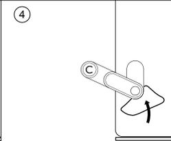
Zum Entfernen der EDGE Mount hebeln Sie mit EDGE Remover auf der rechten unteren Seite. Ziehen Sie niemals die EDGE Mount aus Teil C.
