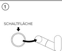
Befestigen Sie das EDGE Light an der EDGE Mount und klicken Sie auf die Schaltfläche, um es zu beleuchten. Die ersten drei Klicks verändern die Lichtintensität und die vierte schaltet sie aus.
